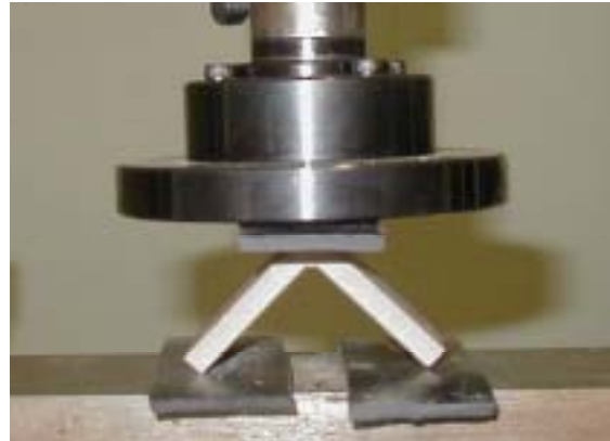
図-1 接着強さの試験方法
